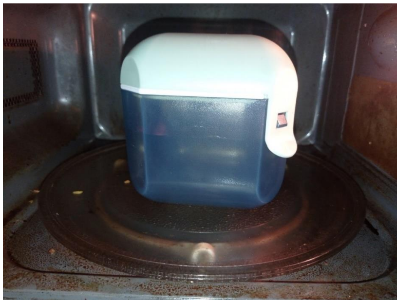
Figura 2. Campioni: FC220857.01- Contenitore JARSTY a contatto con simulante durante prova in microonde
